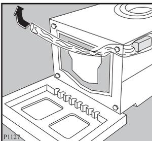
5. Поставьте машину в вертикальное положение и удалите оставшийся болт с задней панели. Вытащите соответствующую пластиковую шпильку.
