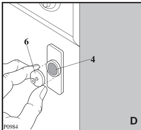
Если дверь должна открываться слева направо, выполните следующее: поменяйте положение пластинок (5-7) и магнита (4). Установите на двери, в правильном положении, ответную часть магнита (6) и петли (1), как описано выше (см. рис. В и Е).
