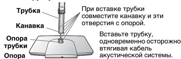
При вставке трубки совместите канавку и эти отверстия с опорой.
