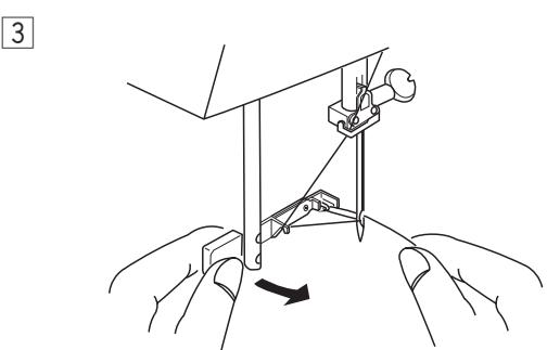
③ Потяните на себя рычаг нитевдевателя ①, чтобы вытянуть игольную нить, как показано на рисунке. Затем подтолкните рычаг нитевдевателя вверх и вытяните нить как показано на рисунке.
