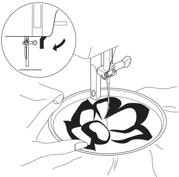
Отключите транспортер ткани и снимите держатель лапки.
