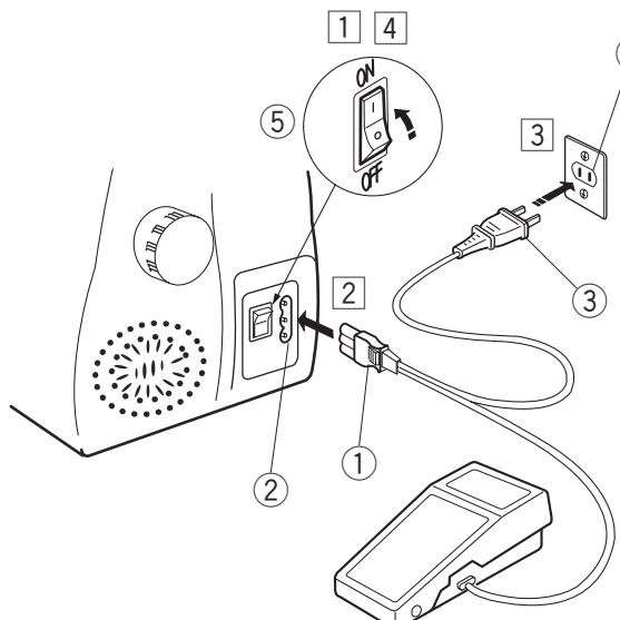
Перед подключением шнура, убедитесь, что напряжение и частота Вашей сети соответствуют напряжению и частоте, указанным на машине.
