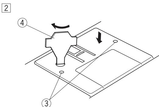
② Поставьте игольную пластину, установив в отверстия две кнопки направителя пластины. Отверткой затяните винты.
