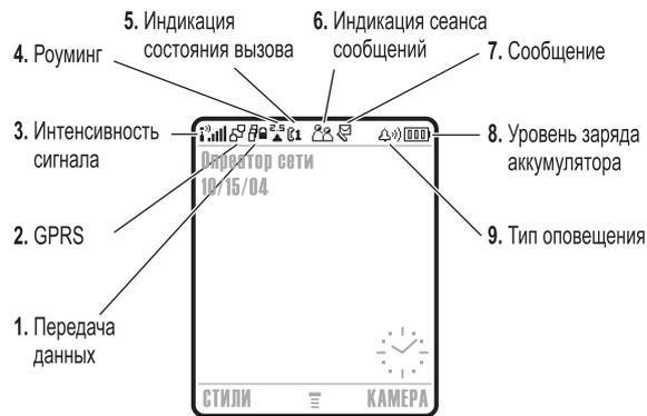
**1. Индикатор передачи данных** - показывает состояние соединения и передачи данных. Индикатор беспроводной связи Bluetooth® а показывает активность соединения Bluetooth. Другие индикаторы:
