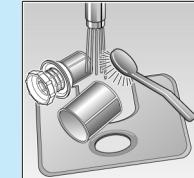
промойте в проточной воде...
