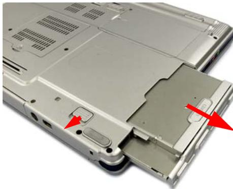
3. Вставьте новый дисковод в универсальный отсек до упора и убедитесь, что защелка перешла в положение LOCK (закрытое положение).
