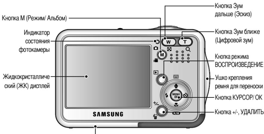
Гнезда для подключения источника питания/ USB-кабеля/
