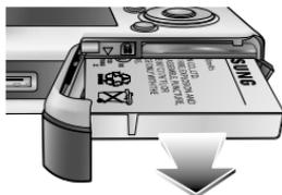
2. Извлеките батарею и закройте крышку отсека.
