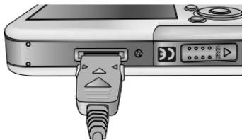
[ Подключение аудио- и видеокабеля к фотокамере ]
