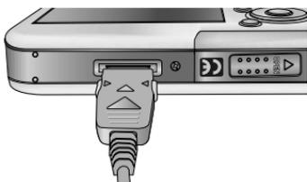
[ Подключение USB-кабеля к фотокамере ]
