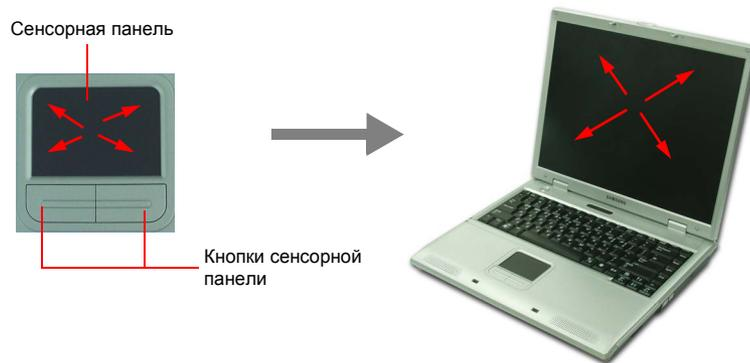
Сенсорная панель вашего компьютера позволяет перемещать указатель по экрану ЖК-дисплея точно так же, как и мышь, которая используется на настольном компьютере. Кнопки сенсорной панели позволяют выполнять посредством указателя различные действия, например, выбирать пункты или выполнять команды.
