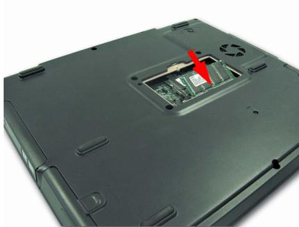
2. Вставьте модуль памяти до щелчка. Если модуль памяти зафиксировался не полностью, нажмите на него, одновременно отжав наружу фиксаторы модуля памяти.
