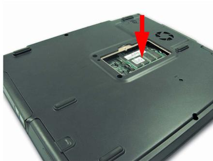
3. Закройте и зафиксируйте крышку отсека модуля памяти с помощью отвертки.
