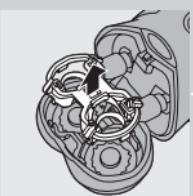
**3** Снимите старые бритвенные головки и вставьте в бритвенный блок новые бритвенные головки. Установите крепёжную рамку в бритвенный блок.
