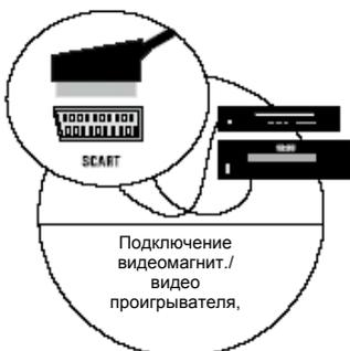
Подключение видеоманит./ видео проигрывателя,
