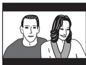
При установке значения **4:3 (Pan & Scan)** широкоэкранные диски отображаются участками, обрезанными слева и справа. Хотя на экране изображение выглядит увеличенным, оно отображается не полностью.
