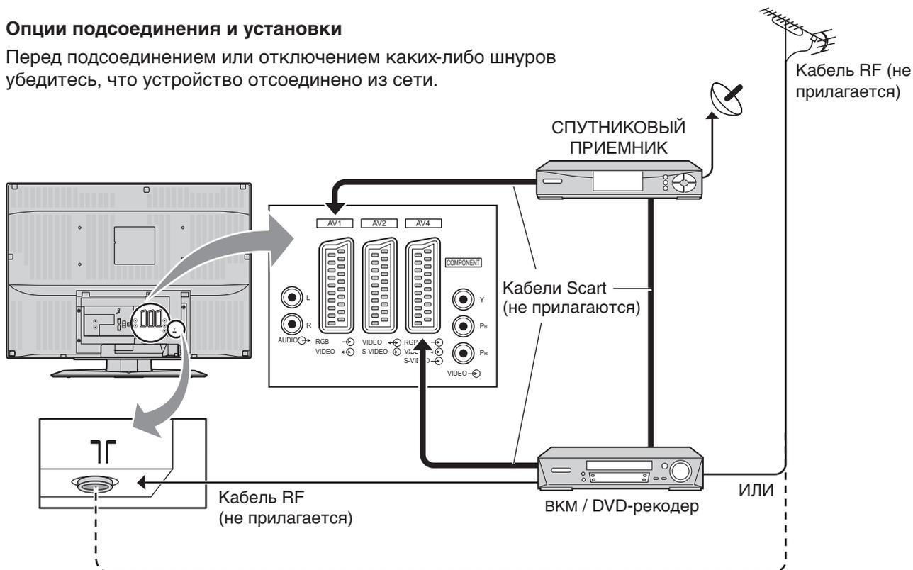
Подсоедините антенну и дополнительное оборудование.
