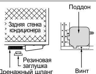
Вид снизу с установленными на место поддоном и дренажным шлангом
