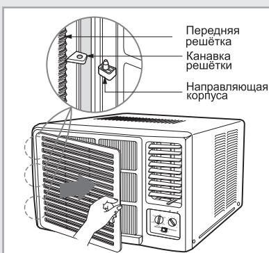
В зависимости от модели в кондиционере имеются два или три желобка передней решётки.
