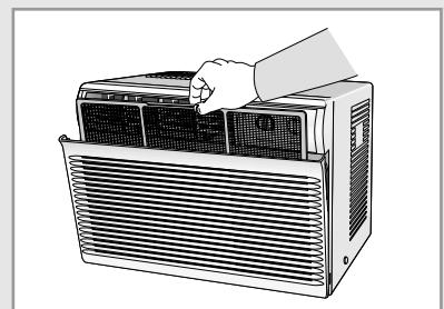
**3** Удалите всю пыль с воздушного фильтра с помощью пылесоса или щётки.
