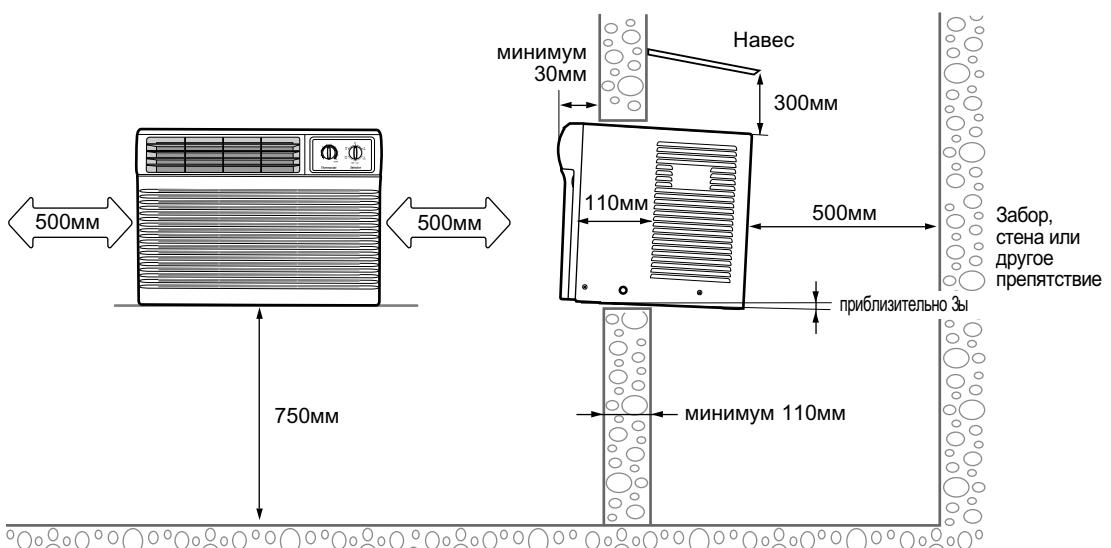
► ◆ Если толщина стены превышает 110 мм, подрежьте стену сзади под углом 45°, если это возможно.
