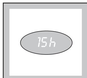
Время задержки появляется на 3 секунды, после чего высвечивается продолжительность выбранной программы. После нажатия кнопки СТАРТ/ПАУЗА начинается отсчет, и значение задержки уменьшается на одну единицу в час. Задержку включения выбранной программы можно отложить до 23 часов с интервалами в один час.
