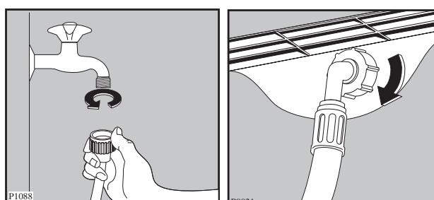
Подключите наливной шланг к водопроводному крану с резьбой 3/4".
