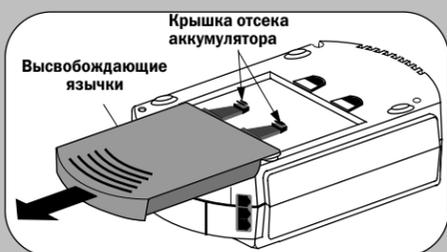
2 Достаньте аккумулятор из устройства UPS. Запомните, какого цвета провод у каждой клеммы. Отсоедините провода от клемм аккумулятора.
