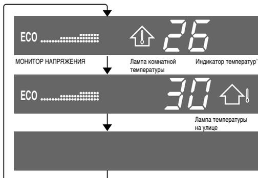
На дисплее показываются комнатная температура и МОНИТОР НАПРЯЖЕНИЯ.
