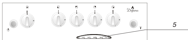
Рис. 9. Панель плиты с электронным индикатором температуры
