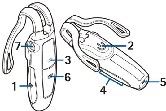
**Кнопка включения/выключения (1):** включение и выключение наушника.
