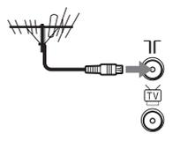
**2** Соедините гнездо TV на DVD-видеомагнитофоне и антенный вход Вашего телевизора с использованием прилагаемого антенного кабеля.
