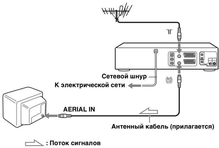
**1** Отсоедините антенный кабель от Вашего телевизора и подсоедините к гнезду ТГ на задней панели DVD-видеомагнитофона.
