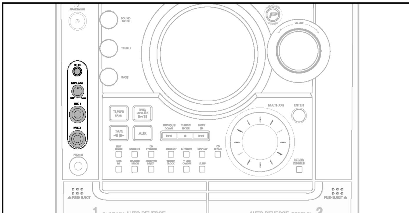
**1** Подключите микрофон к гнезду для микрофона (MIC) на передней панели системы.
