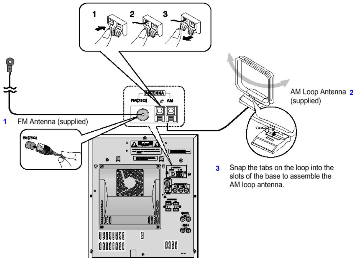
1- FM антенна (поставляется с системой); 2-Рамочная AM антенна (поставляется с системой); 3-Чтобы собрать рамочную AM антенну, вставьте лапки рамки антенны в отверстия ее основания.
