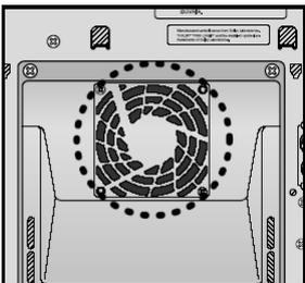
Охлаждающий вентилятор рассеивает тепло, генерируемое внутри системы, обеспечивая ее нормальную работу. Вентилятор начинает вращаться автоматически, подавая внутрь системы более холодный воздух снаружи.
