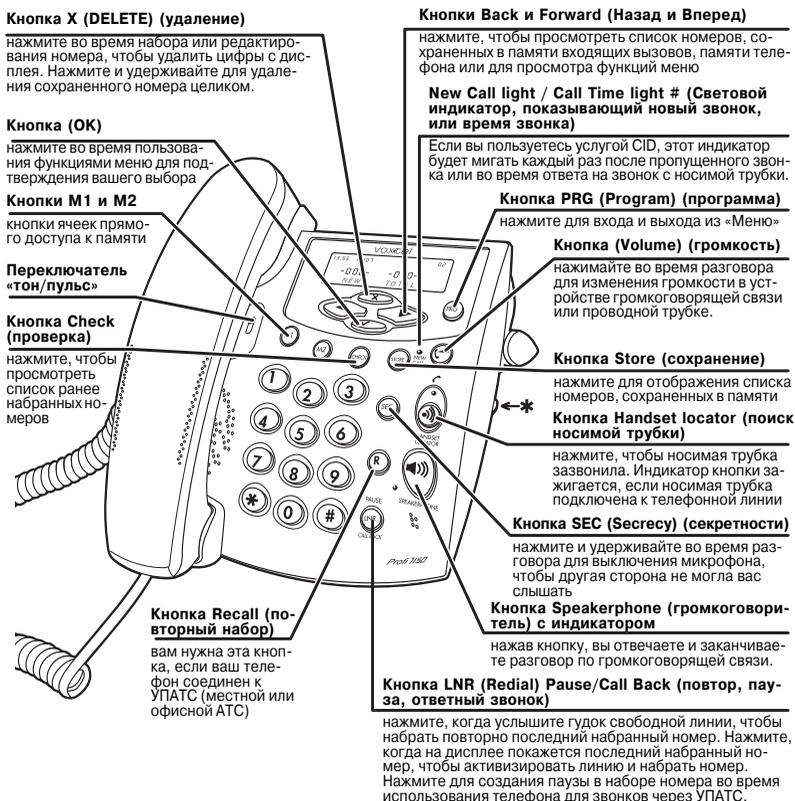
**Замечание:** Данное устройство помимо проводного телефона исполняет также функции базового блока для носимой трубки. Зарядная подставка же служит только для возобновления энергии аккумуляторов носимой трубки и к телефонной линии не подключается.
