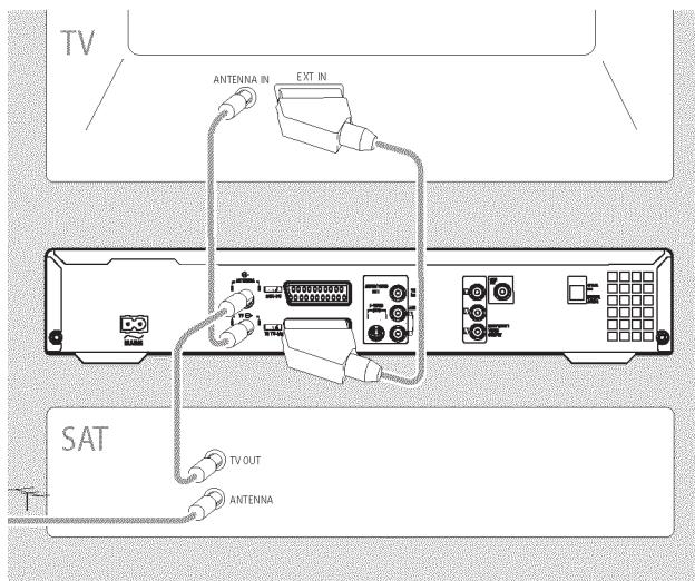
Дополнительное устройство (спутниковый ресивер) должно быть включено перед DVD рекордером (дополнительное устройство - DVD рекордер - телевизор). К разъему **TV OUT** должен быть подключен только телевизор.
