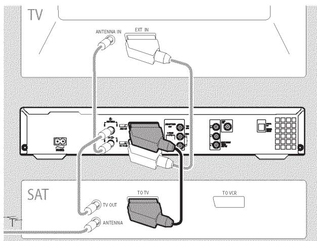
К разъему **EXT2 AUX-I/O** вы можете подключать такие дополнительные устройства, как декодеры, спутниковые ресиверы, видеокамеры и т.п.
