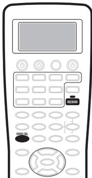
Нажимайте кнопку последовательно для переключения между доступными видеоисточниками. Можно выбрать источники **DVD/LD, TV/SAT, VIDEO, VCR1/DVR, VCR2** или **OFF (ВЫКЛ.)** (отсутствие видеосигнала).
