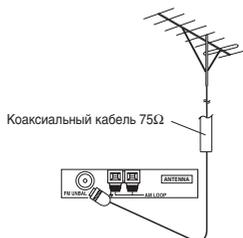
Для улучшения приема в диапазоне AM подключите к разъему **AM LOOP** провод длиной 5–6 м с виниловой изоляцией, не отсоединяя прилагаемую рамочную антенну AM.
