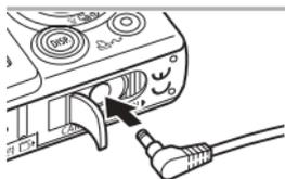
**3** Откройте крышку разъема переходника постоянного тока и подсоедините кабель к разъему DC.
