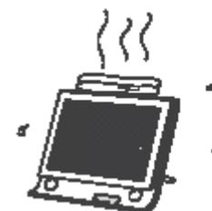
8. **Источники тепла** – Держите изделие вдали от источника тепла, таких как обогреватели, радиаторы, печи и прочие устройства, производящие тепло (также усилители). Элементы из которых изготовлен телевизор чувствительны к теплу. Максимальная окружающая температура, при которой может работать телевизор, составляет 35С.
