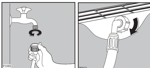
Подключите наливной шланг к водопроводному крану с резьбой 3/4".
