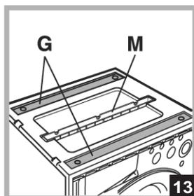
Под крышкой из полистирола (рис. 13) находятся 2 поперечные накладки (**G**); 1 планка (**M**); внутри барабана машины: 4 дополнительные ножки (**H**); 4 винта (**I**); 4 винта (**R**); 4 гайки (**L**); 2 направляющих для плинтуса (нижней декоративной панели) (**Q**).
