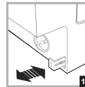
Для установки направляющей (*рис. 9*) выполните следующее: Закрепите уголок **Р** винтом **R**, вставьте направляющую **Q** в специальное отверстие, разместите ее в желаемом положении и закрепите с помощью уголка **Р** и винта **R**.
