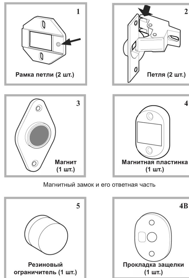
Магнитный замок и его ответная часть
