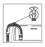
или поместить его конец в раковину или в ванну, прикрепив прилагающуюся направляющую к крану (смотреть рисунок). Свободный конец сливного шланга не должен быть погружен в воду.
