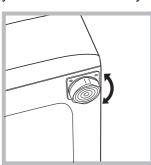
(см. рис.). Для этого сначала ослабьте контргайку, после завершения регулировки контргайку затяните.
