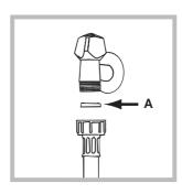
1. Вставьте прокладку А в конец заливного шланга и наверните его на вывод водопровода холодной воды с резьбовым отверстием 3/4 дюйма (см. рис.). Перед подсоединением откройте водопроводный кран и дайте стечь грязной воде.
