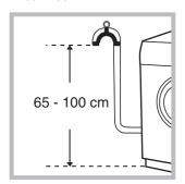
Подсоединить сливной шланг, не сгибая его, к сливному трубопроводу или к настенному сливу, расположенному на высоте 65 – 100 см от пола.
