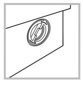
2. выверните крышку фильтра, вращая ее против часовой стрелки (см. рис.): из насоса может вылиться немного воды — это нормальное явление.
