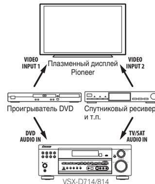
Для оптимального использования функций SR+ следует подключить компоненты-источники сигнала (проигрыватель DVD и т.д.) несколько иначе, чем описано в данном разделе. Подключите видеовыходы каждого компонента непосредственно к плазменному дисплею, а аудиовыходы (аналоговые и/или цифровые) - к ресиверу.
