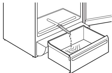
**Совет:** Вы можете ускорить процесс размораживания, поставив в морозильную камеру кастрюлю с горячей водой. Кроме того следует вынимать отвалившиеся кусочки льда, не дожидаясь полного размораживания.
