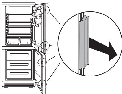
**3. Защитные части крепления дверцы следует удалять при открытой дверце.**
