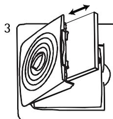
3. Вставьте новый угольный фильтр в крепление на стенке решетки и прижмите решетку таким образом, чтобы она механически зафиксировалась.
