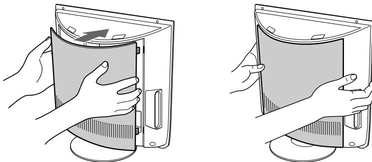
**ⓘ** Заднюю крышку можно не устанавливать, если Вы используете кронштейн для настенной установки телевизора SU-W210 (опция).
