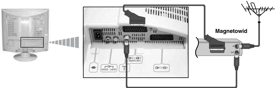
**⚠** Antenę należy podłączyć przed podłączeniem typu Scart.
