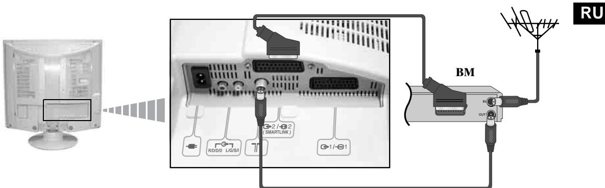
**⚠** Перед тем как подключать кабель к Scart-разъему, произведите подключение антенны.
