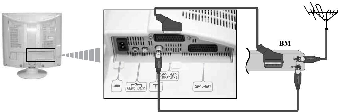
**⚠** Перед тем как подключать кабель к Scart-разъему, произведите подключение антенны.
