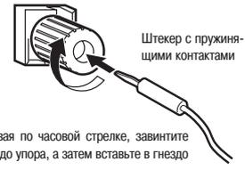
Поворачивая по часовой стрелке, закрутите фиксатор до упора, а затем вставьте в гнездо штекера.
