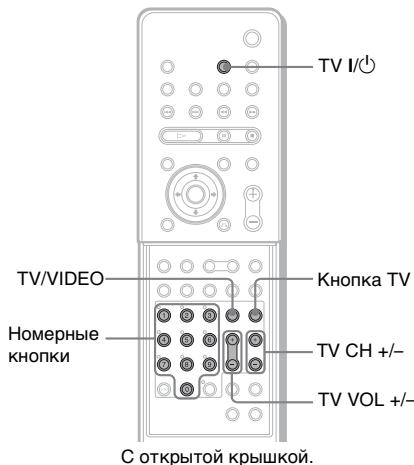
**Удерживая нажатой кнопку TV I/O, с помощьюnumерованных кнопок введите код 'производителя телевизора' (см. таблицу). Затем отпустите кнопку TV I/O.**
