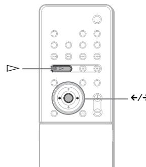
Текущее изображение можно поворачивать с помощью кнопок ←→.
