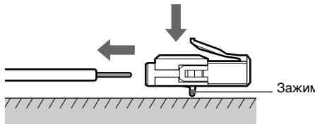
Повернув разъем зажимом вниз, прижмите его к ровной поверхности и извлеките провода из разъема.
