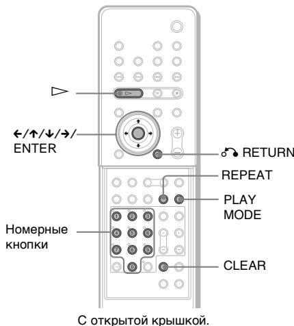
**1 В режиме остановки нажмите кнопку PLAY MODE до тех пор, пока на дисплее передней панели не появится индикация "PGM".**
