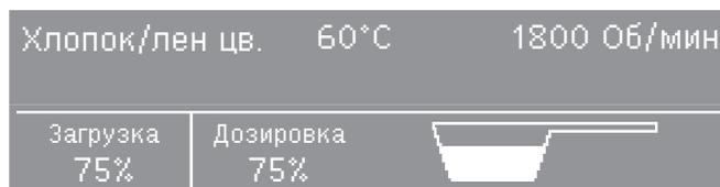
Индикация загрузки производится шагами в 25%. Загрузка, составляющая менее 25%, или отсутствие белья в барабане отображаются значением <25%. Перегрузка барабана отображается миганием значения >100%. В программах *Хлопок/лен* и *Хлопок/лен цв.* индикация перегрузки не отображается.
