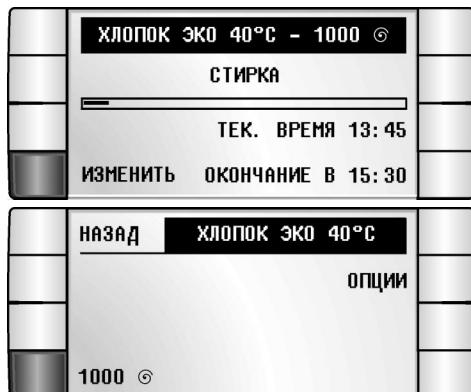
Во время выполнения выбранной программы можно изменить скорость отжима, и дополнительные функции (исключение: «ПРЕДВ. СТИРКА») могут быть включены или выключены.
