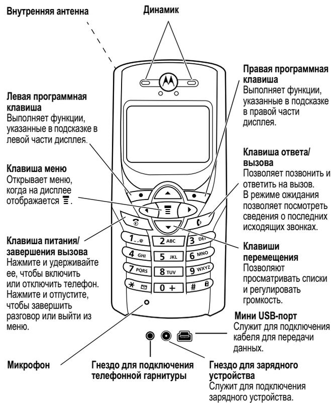
Съемные панели и клавиатуры телефона C350 можно менять (см. стр. 30). Внешний вид вашего телефона может отличаться от приведенного на рисунке. Расположение клавиш и их функции одинаковы для любых панелей.
