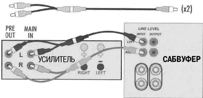
**Б:** Вам понадобятся два стереофонических (или четыре одножильных) экранированных кабеля формата RCA. Стереофоническим кабелем соедините разъемы «Input» [Вход] из группы «Line Level» [Линейный уровень] на сабвуфере с разъемами усилителя «Pre Out» [Выход предусилителя]. Вторым стереофоническим кабелем соедините разъемы «Output» [Выход] из группы «Line Level» на сабвуфере с разъемами усилителя «Main In» [Вход усилителя мощности]. Сабвуфер теперь встроен в контур системы.
