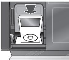
⑤ Нажмите на рычаг стыковочного выключателя, чтобы он со щелчком вернулся в исходное положение.
