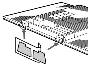
Закройте два отверстия в нижней части телевизора, используя прилагающиеся пластинки. Снимите с пластинок защитную пленку. Затем отделите пластинки от бумаги и наложите их на отверстия.
