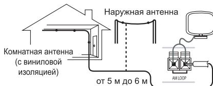
Для подключения внешней FM-антенны используйте Соединитель PAL.
