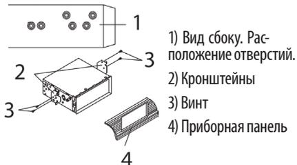
Выберите позицию, при которой винтовые отверстия кронштейнов, закрепленных в автомобиле, и винтовые отверстия приемника (отмеченные соответствующими буквами названия марки машины «Т» – Toyota или «N» – Nissan) совпадут, и закрепите проигрыватель при помощи 2-х винтов (5x5 мм) с каждой стороны.
