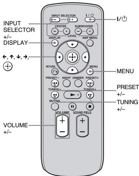
**1 Нажмите кнопку INPUT SELECTOR + или – пока индикация “FM” или “AM” не отобразится на дисплее передней панели.**
