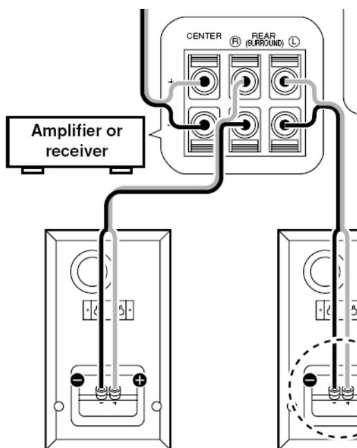
Повторите аналогичным образом процедуру подключения для двух тыловых колонок, используя соответствующие клеммы в усилителе или ресивере.
