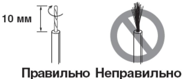
**Примечание:** Не допускайте соприкосновения оголенных проводов разной полярности друг с другом, поскольку это может вызвать неисправность динамика, усилителя или обоих компонентов. Не вставляйте изолированную часть кабеля в отверстие так как звук в этом случае не будет воспроизводиться.
