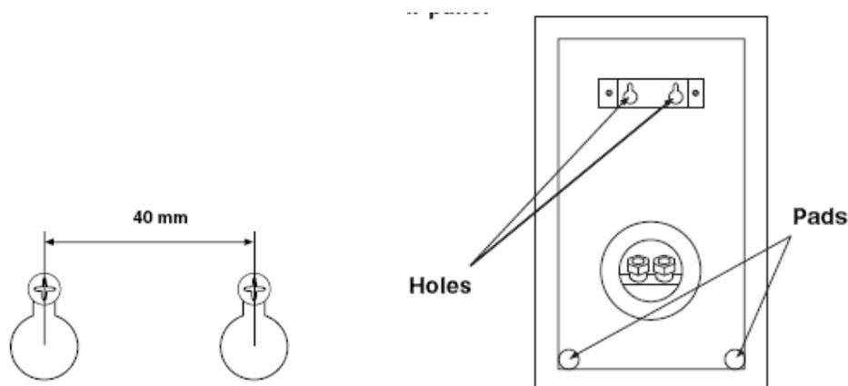
Крепление производится с использованием встроенной в колонку крепежной скобы, в которой имеются отверстия (на рисунке – Holes). Специальные резиновые наклейки (Pads) для ровного положения колонки и свободного соединения кабеля.
