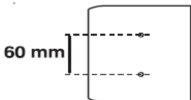
Вы можете использовать крепежные отверстия в нижней части тыловых колонок для крепления на стенды. Расстояние между отверстиями 6 см, глубина 10 мм. Перед инсталляцией пожалуйста изучите инструкцию к стендам.
