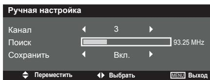
С помощью кнопок **VOL+/VOL-** выберите канал для настройки. Кнопками **CH+/CH-** выберите опцию **Поиск**. Кнопками **VOL+/VOL-** запустите процедуру ручной настройки на канал. Когда канал найден, кнопками **CH+/CH-** выберите опцию **Сохранить**, с помощью кнопок **VOL+/VOL-** выберите **Вкл.** Канал будет сохранен в памяти системы.
