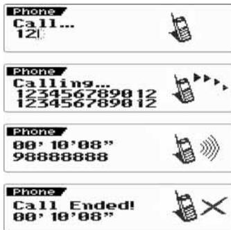
**Примечание.** CD-ресивер автоматически отключает звук только с началом набора номера.
