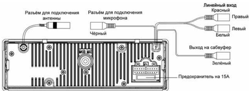
Для некоторых автомобилей VW/Audi или Opel необходимо поменять подключение проводов питания, как показано на рисунке, иначе все настройки будут стираться при каждом выключении зажигания автомобиля. Обратитесь к ближайшему автомобильному дилеру перед установкой.
