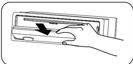
1. Удерживая панель в наклонном положении, вставьте ее в левый упор.
