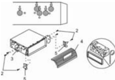
сторон устройства не менее чем в двух местах. Для этого используйте либо крепежные винты (5 x 8 мм), либо винты с потайной головкой (4 x 8 мм), в зависимости от типа резьбовых отверстий на кронштейне.
