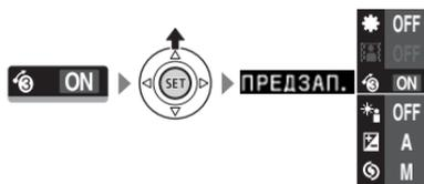
Функции, отображаемые в подсказках по функциям джойстика, зависят от режима работы. По умолчанию подсказка по функциям джойстика свернута. Для ее отображения нажмите джойстик (
