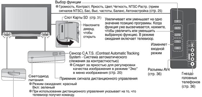
Переключатель включения / выключения сетевого питания
