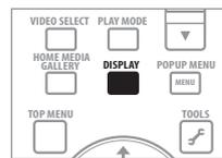
Информация диска отображается на телевизионном экране. Информация переключается при каждом нажатии кнопки.
