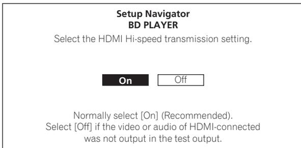
Если **HDMI High-Speed Transmission** установлен на **On**, используйте кабель High Speed HDMI™. Картинка и звучание могут не выводиться соответствующим образом при использовании любого другого кабеля HDMI (стандартного кабеля HDMI™).
